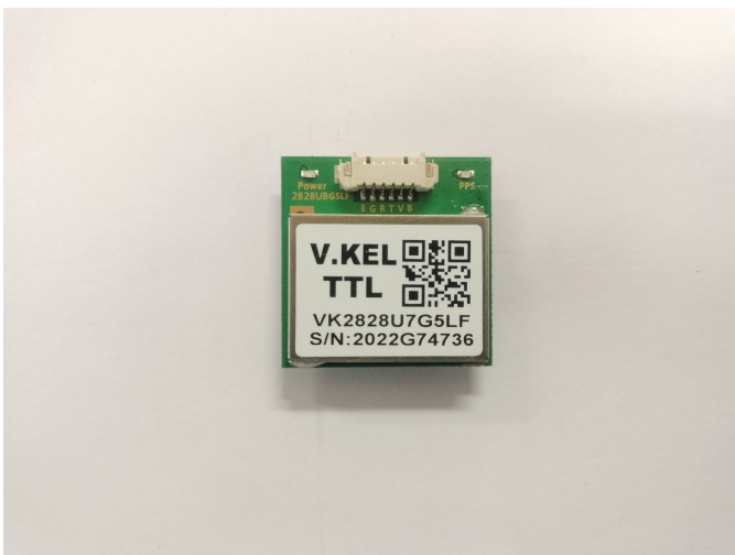
Fig.2 - Módulo GPS com interface UART/TTL.
