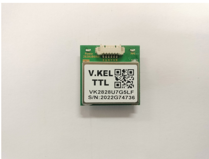
Fig.2 - Módulo GPS com interface UART/TTL.
